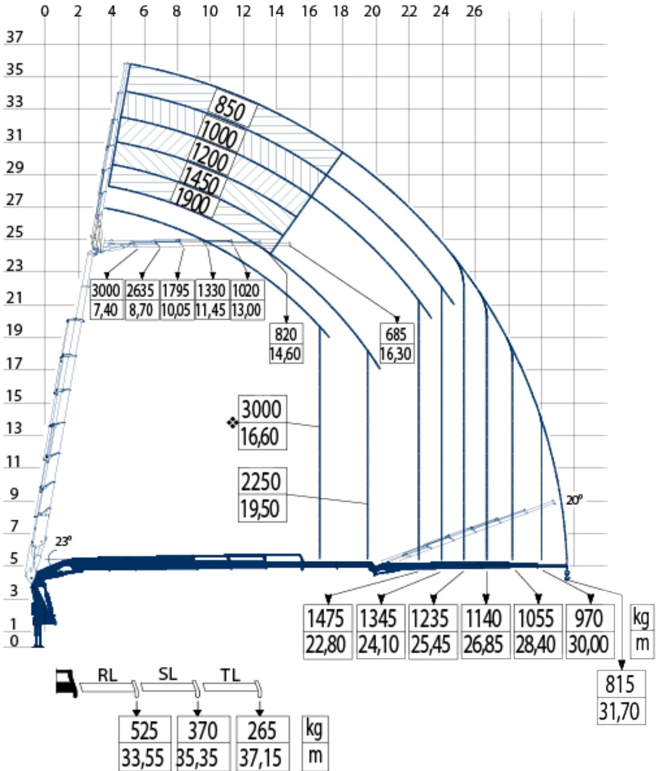
Avec JIB JDP (Jib Dual Power - augmente la puissance du jib de 30%)
